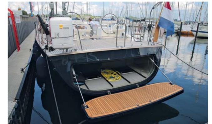
**Grand luxe.** Ce vaste garage à annexe doit être bien pratique ! Le tableau arrière bascule électriquement, cela va de soi.
