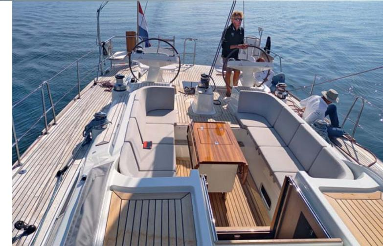
**Double cockpit.** A l'avant, une zone dévolue aux passagers. Sur l'arrière, le cockpit de manœuvre et les postes de barre sont de plain-pied avec le pont.
